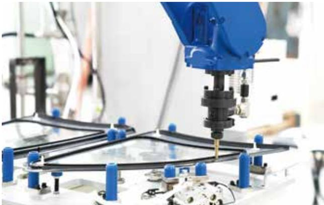
2枚のガラスの間に透明の中間膜(ビニル系フィルム)をはさみ貼り合せます。この中間膜は湿湿度に敏感な素材のため保管の際は低温低湿な環境が必要となります。また、貼合せ時は接着面に水分が含まれていると気泡が発生し不良の原因となるため、脱湿するためにカサパーが使用されています。
