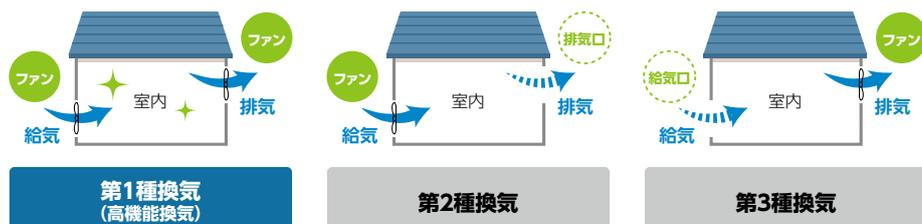
確実な給排気が可能で、室内に汚染物質が滞留しにくい。熱交換をすれば高機能換気となる。
