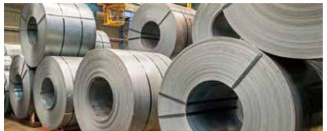
焼鈍工程を終えたコイルは100℃程度で冷却ヤードに搬入され、カサパーで冷却除湿された空気にて40℃まで冷却されます。この際コイルヤード内の湿度を30%以下に抑えて錆の発生を防いでいます。また、短時間で冷却することにより仕掛り時間を短縮しています。
