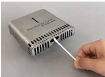
オゾン吹き出し口の中に見える電極部を水にぬらした綿棒で優しくこすります。フィルターなどの交換は不要。メンテナンスの手間とコストが省けます。
