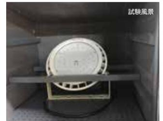
試験条件:H<sub>2</sub>S10~15ppm, 40℃, 80±5%RH, 720時間 (JIS C 60068-2-43による)
